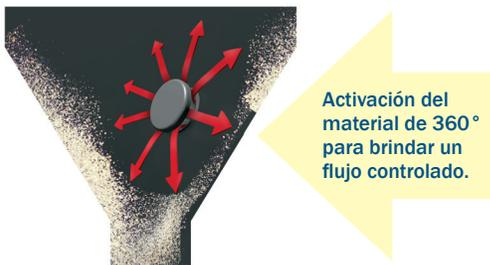
Cada boquilla del **AirSweep** dirige una ráfaga de alta presión y alto volumen de 360° de aire comprimido o gas inerte a lo largo de las paredes interiores de los equipos o recipientes de proceso, rompiendo la fricción para levantar y barrer el material estancado de nuevo hacia la corriente de flujo. El diseño patentado de la boquilla asegura un resellado inmediato después de cada pulso para eliminar la retroalimentación del material.
